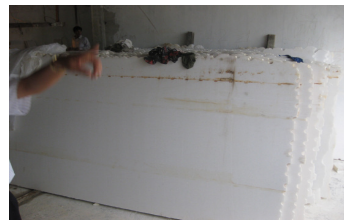
Đá xẻ tấm kích thước từ 1.2 đến 1.5 m được sản xuất tại nhà máy sx đá xẻ, đá kiểm thuộc khu CN
